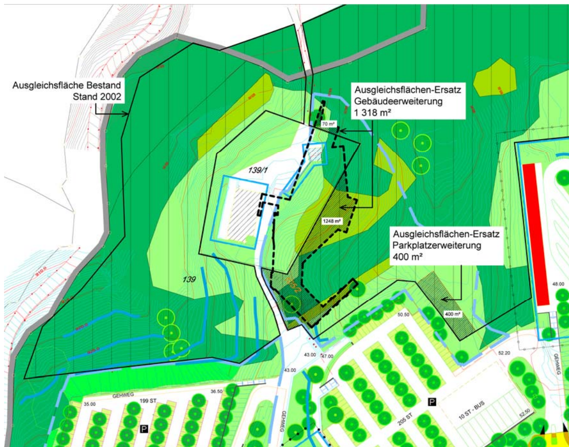
Übersichtsplan Ausgleichsfläche 2002 mit Überlagerung Baukörper und Parkplatz
